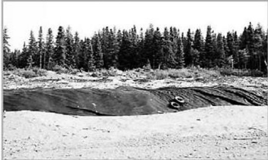
Voici l'endroit où sont déchargées les cargaisons de résidus marins pour l'étape de putréfaction. On aperçoit la toile compostex pour limiter les odeurs. « Ici il y a 500 tonnes de résidus de buccins, 600 tonnes de résidus de crabes et 2 500 tonnes de résidus d'écorces », explique Dany Sénéchal.
